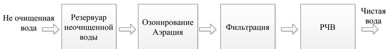
Рис. 2.3.1. Блок-схема станции водоочистки
