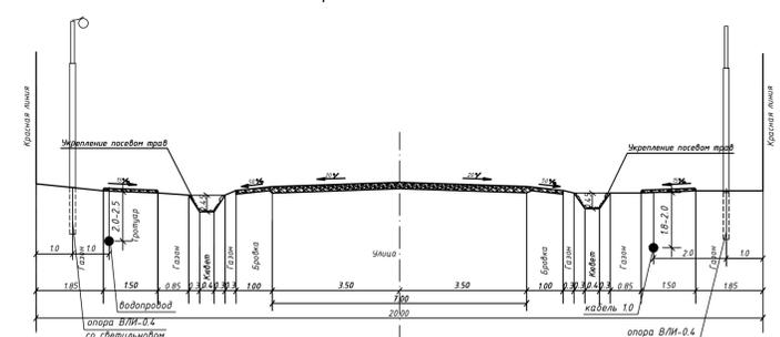
**ПОПЕРЕЧНЫЙ ПРОФИЛЬ ПРИ ШИРИНЕ ПРОЕЗЖЕЙ ЧАСТИ 5,5м
