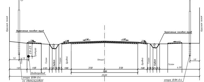
**ПОПЕРЕЧНЫЙ ПРОФИЛЬ ПРИ ШИРИНЕ ПРОЕЗЖЕЙ ЧАСТИ 7,0м
