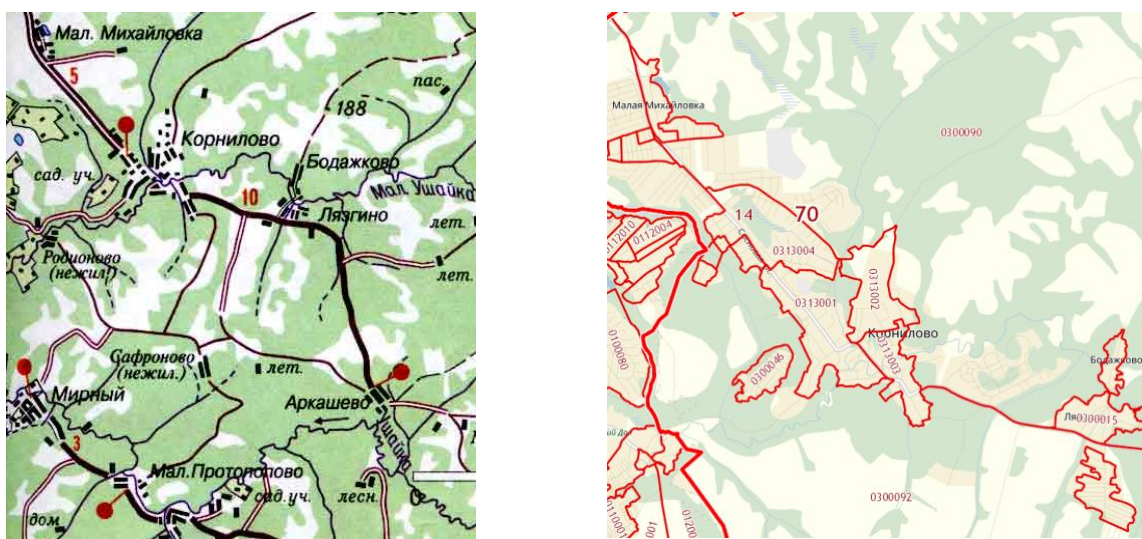
Рис. 1.1. Кадастровое деление Корниловского СП: 70 – номер Томской области в РФ; 14- номер Томского района в Томской области; 03.....- номер кадастровой зоны
